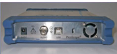
(von links nach rechts) Stecker für Netzgerät, AUXIO: Anschluss für zukünftige Funktionserweiterungen, USB-Anschluss, Lüfter.
