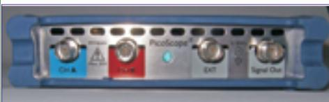
(von links nach rechts): Kanal A ist wie auch am Bildschirm blau, so wie auch Kanal B entsprechend farblich dargestellt wird. LED: Betriebsanzeige, EXT: Externer Trigger Eingang, Signal-generator
