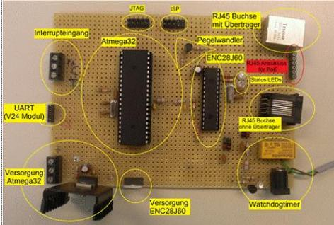
Auswertung der aufbereiteten Impulse mit einem Atmega32 und Schnittstelle (RJ45) zur Umweltdatenbank mit einem Ethernetcontroller (ENC28J60).
