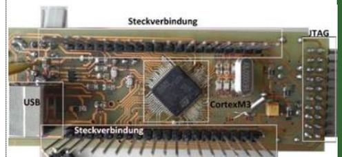
Prototyp des Steckbrettadapters. Die durchkontaktierte Leiterplatte wurde in der HTL-Hollabrunn produziert.
