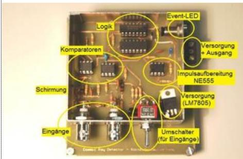
Koinkidenzauswerteplatine. Hier werden die Impulse der Photomultiplier erfasst und auf Koinkidenz überprüft. Weiters werden die Impulse mit einem NE555 für den Mikrocontroller aufbereitet.
