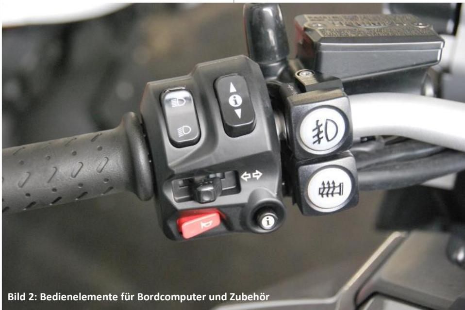
Bild 2: Bedienelemente für Bordcomputer und Zubehör
