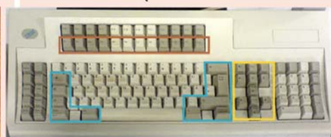
IBM Modell M, 1989, 101 Tasten, oben und ihre Vorläufer die IBM-AT-Tastatur, 84 Tasten links unten und die IBM-Terminaltastatur, 122 Tasten, rechts unten
