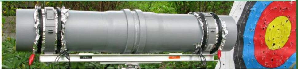
**Bild 7: Versuchsanordnung zur Messung der Pfeilgeschwindigkeit**
