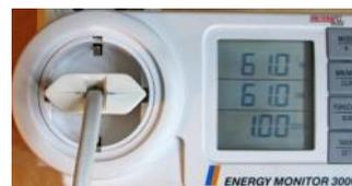
Messung an einer eingeschalteten Glühlampe: Scheinleistung und Wirkleistung sind identisch.
