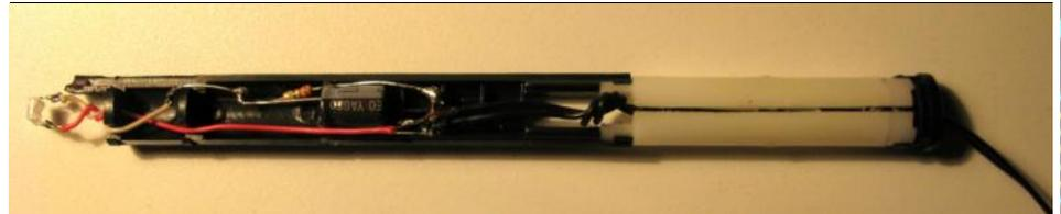
Der Sensor setzt Helligkeitsänderungen in des Sensors. Links die Öffnung für die Spannungsänderungen um, die am Photodiode, rechts das Stereokabel zum PC.
