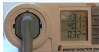
Messung an einem heruntergefahrenen PC: Die Wirkleistung macht nur einen Teil der Scheinleistung aus.
