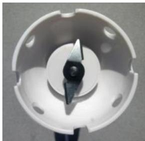
Die Lichtreflexion des einen Messers des Stabmixers wurde mit der Photodiode erfasst. Die Drehzahl wurde aus dem oben gemessenen Impulsabstand mit  $60000 / 4 = 15000$  U/min bestimmt.
