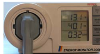
Messung an einem heruntergefahrenen PC: Die Wirkleistung macht nur einen Teil der Scheinleistung aus.
