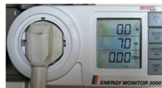
Messung an einer ausgeschalteten Waschmaschine: die Scheinleistung enthält keine Wirkleistung.
