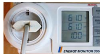
Messung an einer eingeschalteten Glühlampe: Scheinleistung und Wirkleistung sind identisch.
