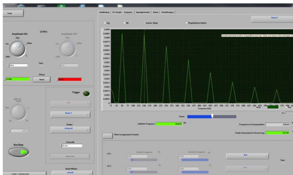
Spektrum des Stromverlaufs mit ungeradzahigen Oberwellen (siehe Hinweis)
