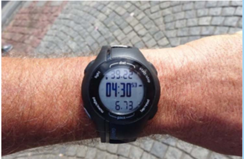
Abb. 1: mit dem FR 210 am linken Handgelenk beim Marathon in Ostrava, Tschechien am 6. September 2015 (Anzeige: oben die zurückgelegte Distanz, in der Mitte die bisherige Laufzeit, unten km/h: wegen der Tempoverringerung beim Fotografieren mit der rechten Hand entsprechend geringer)
