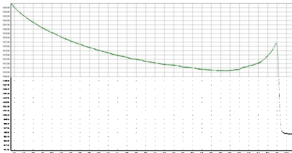
Diagramm 1: Druckverlauf bei abnehmendem Volumen eines Luftballons
