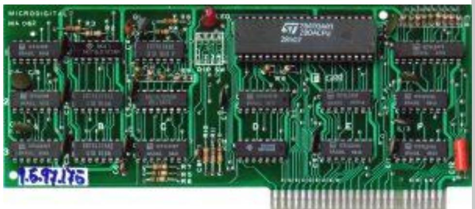
Mit der eingebauten Z80-Karte konnte man dann auf einem Apple IIe das CP/M-Betriebssystem von Digital Research installieren. Es funktionierte bereits so, wie man das später vom IBM-PC als MSDOS kennen lernen sollte. Damit war der Apple IIe auch für die CP/M-Welt vorbereitet.
