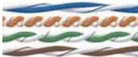
Übertriebene Darstellung der unterschiedlichen Verdrehungen der Kabelpaare eines Twisted Pair-Kupferkabels (Quelle: www.siemon.com )
