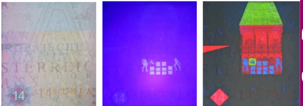
Dokumentenprüfung: Reisepass bei weißem Licht, bei UV 395 nm, bei UV 365 nm.
