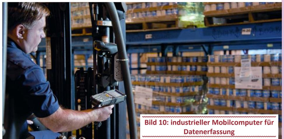
**Bild 10: industrieller Mobilcomputer für Datenerfassung**
