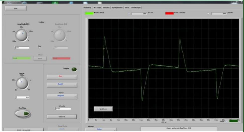
Stromverlauf eines Schaltnetzteils
