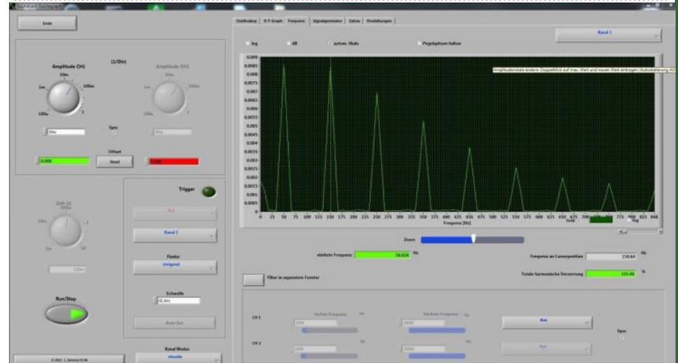
Frequenzspektrum eines Schaltnetzteils
