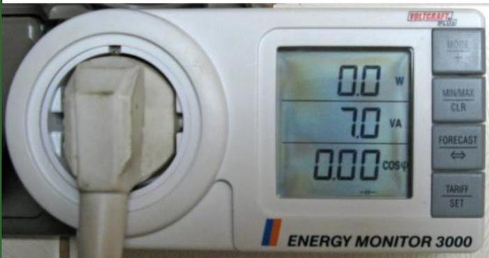
**Messung an einer ausgeschalteten Waschmaschine: die Scheinleistung enthält keine Wirkleistung.**
