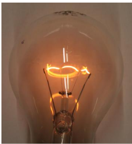
Abbildung 2: Leuchtfaden einer Glühlampe (eigenes Foto)
