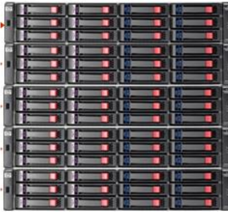
MSA StorageWorks 2000i: Maximale Ausbaustufe mit 60 LFF-Platten – HP
