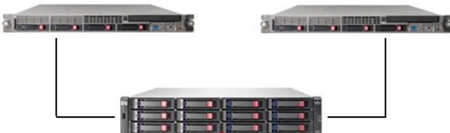
DAS: HP MSA 2000sa (max. 4 Server können auf dieses Disk-Array zugreifen)
