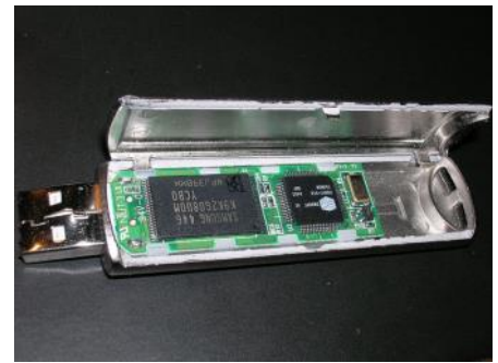
Das Innere eines USB-Sticks: Links der Flash-Speicherchip, rechts der Controllerchip. (Wikipedia)
