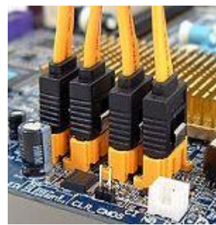
Anschluss von SATA-II-Kabeln www.elektronik-kompodium.de
