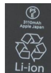
Akku iPhone 11 (3,83 V Gleichspannung, 11,91 Wh Energie, Kapazität 3110 mAh) www.ifixit.com
