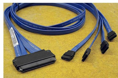
**SFF-8484-Kabel für den Anschluss von max. 4 SAS-Festplatten**
