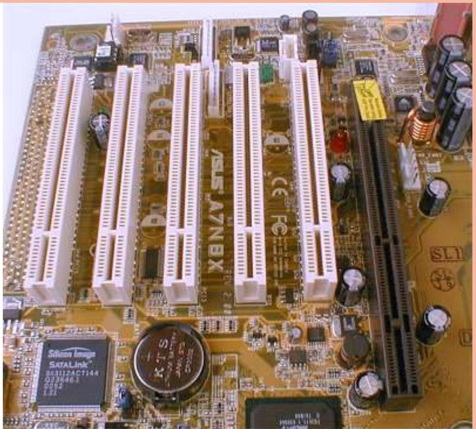
**Abbildung: Fünf PCI-Slots auf dem ASUS-Motherboard A7N8X Deluxe, rechts daneben der dunkler eingefärbte AGP2.0/3.0-Steckplatz (Quelle: [www.planet3dnw.de](http://www.planet3dnw.de))**
