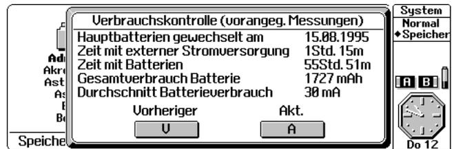
Batteriezustandskontrolle des Systemschirms (rechts Batterie-warnung)
