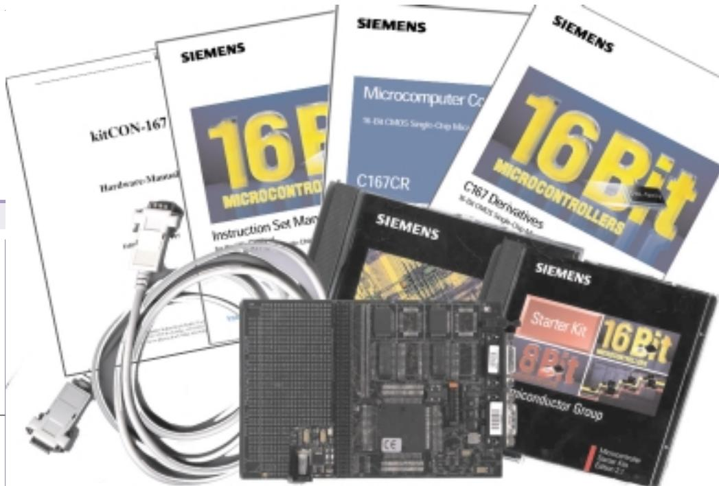
Das Interrupt System kommt fast einem Betriebssystem gleich: 16 verschiedene Interrupt-Prioritätsebenen, insgesamt 56 Interruptquellen. Zusätzliche 8 PEC (Peripheral Event Control) Kanäle erledigen bei Ereignissen beliebige Speichertrans-
