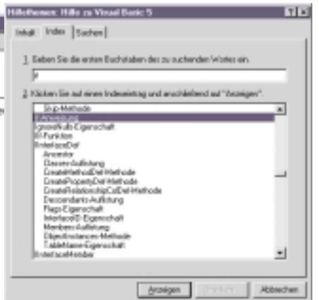
Hat man eine Anweisung markiert, so erscheint bei Drücken der **«F1»**-Taste sofort die Hilfe zum markierten Wort. Beispiel: Hilfe zur **if**-Anweisung.
