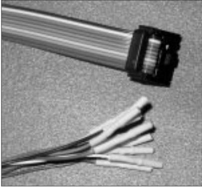
An das eine Ende ist eine 10-poligen Federleiste angeschlossen. Das andere Ende des Flachbandkabels wurde adernweise aufgetrennt. An die Leitungen wurden Crimpkontakte gelötet und mit Schrumpfschlauch überzogen.
