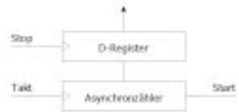
Als alternative Lösung wählten wir einen synchronen Zähler. Dazu benutzten wir ein besonderes Design eines synchronen Zählers, das höhere Taktraten verarbeiten kann, dafür allerdings einen größeren Platzbedarf hat. Die Start- und Stopfunktion mit D-Register ließen wir gleich.
