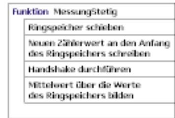
Steuerungshardware des Zählers. Im nächsten Schritt errechnet der MC den Mittelwert aller im Ringspeicher enthaltenen Zählerwerte.
