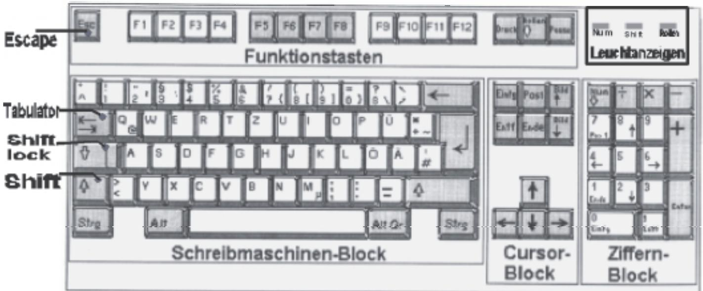
Erweiterte Schreibmaschinentastatur (104 Tasten sind Standard). Bezeichnung „MF2“: Multifunktions-Tastatur. Die Tastatur hat zur Entlastung der CPU einen eigenen Prozessor; Datenübertragung mittels serieller Schnittstelle.
