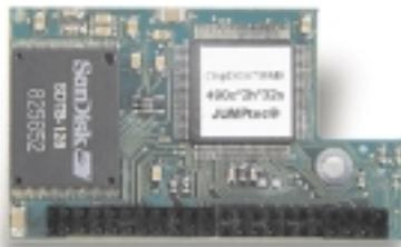
Die Setup Parameter des Bios werden im Flash EPROM des Boards gespeichert. Es ist daher auch möglich, das Board ohne Systembatterie zu benutzen.
