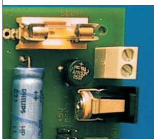
ckengleichrichter vorgeschaltet. Die Anschlüsse sind in zweifacher Ausführung vorhanden, nämlich als Klinenstecker (ist auf jedem Steckernetzteil vorhanden) und zweipoliger Print-
