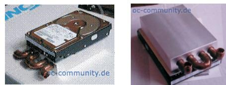
Bild 4 : Wasserkühlungen für Festplatten (Beispiele)
