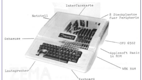
Die Möglichkeit der Erweiterung eines Rechners über „Slots“ wird in der Literatur als Woz-Prinzip bezeichnet. Ein Rechner ohne Möglichkeit zur Hardwareerweiterung ist heute undenkbar
