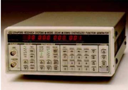
Der DS 345 erzeugt Sinus, Rechteck, Dreieck und Rampen Funktionen mit 1µHz Auflösung (DDS) sowie Arbitrary Funktionen bis zu 16.300 Speicherpunkte, 12 bit Auflösung und 40 MSamples/sec
