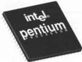
Abbildung: Pentium-CPU-Chip (Foto: intel)
