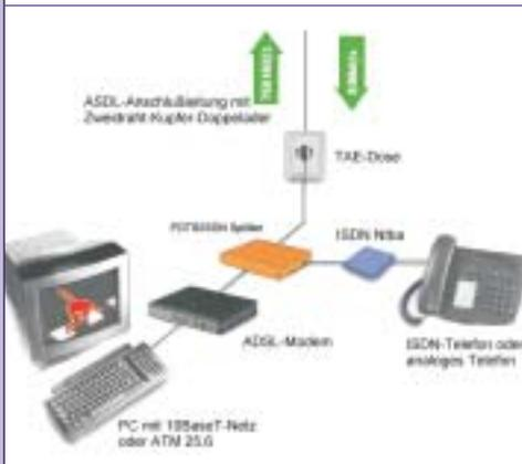
Die Telekom sieht wegen der hervorragend ausgebauten Ortsnetze beim ADSL-Regelbetrieb keinerlei Probleme: Nahezu alle Teilnehmer sind direkt angebunden und 70 bis 80 Prozent der Anschlussleitungen sind kürzer als 1,7 Kilometer. In der Vermittlungsstelle endet die Telefonleitung im so genannten DSL Access Multiplexer (DSL-AM). Er leitet den Telefonverkehr an den Telefonnetz-Switch weiter; der Datenverkehr wird direkt dem Datennetz des Betreibers zugeführt.
