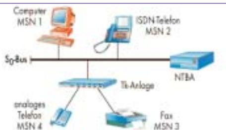
An einen Mehrgeräteanschluss können insgesamt 12 ISDN-Steckdosen angeschlossen werden, wobei die Anzahl der angeschlossenen Endgeräte grundsätzlich auf 8 Geräte beschränkt ist (+ 4 Daten-Endeinrichtungen). Es dürfen maximal 4 ISDN-Telefone betrieben werden, da sonst die Spannungsversorgung des NT (Netzabschluss) nicht ausreicht. Wenn die Telefone ihre eigene Stromversorgung besitzen, gilt diese Beschränkung natürlich nicht. Die ISDN-Steckdosen (IAE) werden dabei parallel geschaltet.
