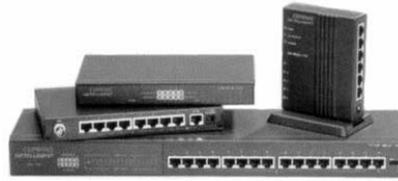
Sternverteiler (Hub), an den etwa 6-12 Clients, der Server und der Netzwerkdrucker angeschlossen werden können (Foto: C2000) Hubs arbeiten auf der Bitübertragungsschicht (Schicht 1) des OSI-Modells. Sie haben reine Verteilfunktion. Alle Stationen die an einem Hub angeschlossen sind, teilen sich die gesamte Bandbreite die durch den Hub zu Verfügung steht (z. B. 10 MBit/s oder 100 MBit/s). Die Verbindung von Computer zum Hub verfügt nur kurzzeitig über diese Bandbreite.
