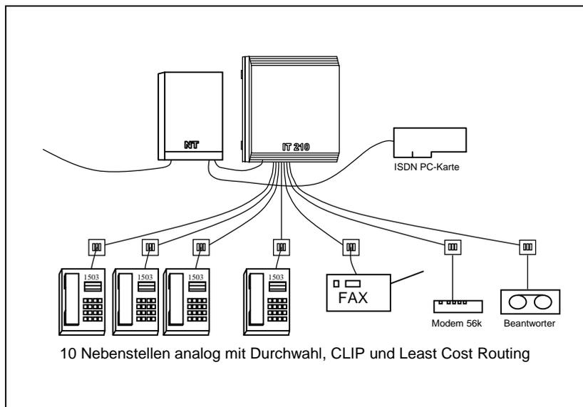
Direkte Durchwahl zu den Nebenstellen und die ISDN PC-Karte direkt am S-Bus. Die ISDN-Karte nimmt Rufe mit Diensterkennung „64kBit data“ entgegen. Gespräche mit Kennung 3,1kHz oder „speech“ leitet die IT210 je nach Durchwahl an das passende Endgerät (Tel., Fax, Modem, ...) weiter. PC-Karte und IT210 können jede im Bedarfsfall mit beiden B-Kanälen (Amtsleitungen) arbeiten.
