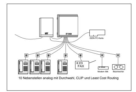
Direkte Durchwahl zu den Nebenstellen und die ISDN PC-Karte direkt am S-Bus. Die ISDN-Karte nimmt Rufe mit Diensterkennung "64kBit data" entgegen. Gespräche mit Kennung 3,1kHz oder "speech" leitet die IT210 je nach Durchwahl an das passende Endgerät (Tel., Fax, Modem, ....) weiter. PC-Karte und IT210 können jede im Bedarfsfall mit beiden B-Kanälen (Amtsleitungen) arbeiten.
