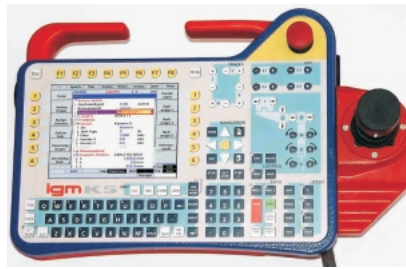
Bild 4: Neue igm K5 Konsole mit Joystick. Gut sieht man hier die Optimierung der Bedienkonsole auf den Schweiß-einsatz.
