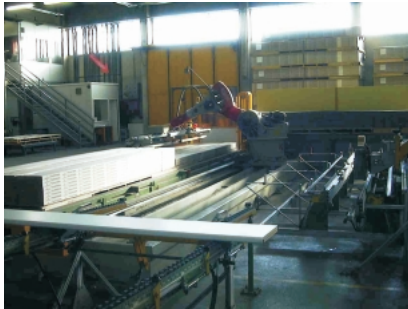
Bild 7: Roboter legt Paket auf einer Palette ab
