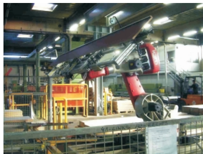
Bild 3: Roboter hat das Brett vom Wender geholt und wartet auf das nächste Brett um es drauflegen zu können.
