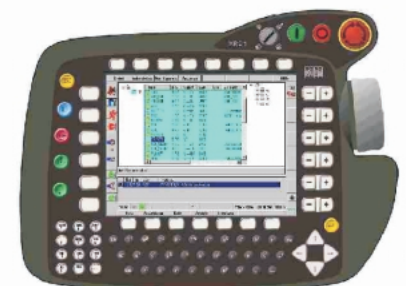
Bild 8: KCP ( Kuka Control Panel) Neben den windows Standarttasten sind viele Funktionstasten vorhanden die sich je nach Einstellung ändern.
