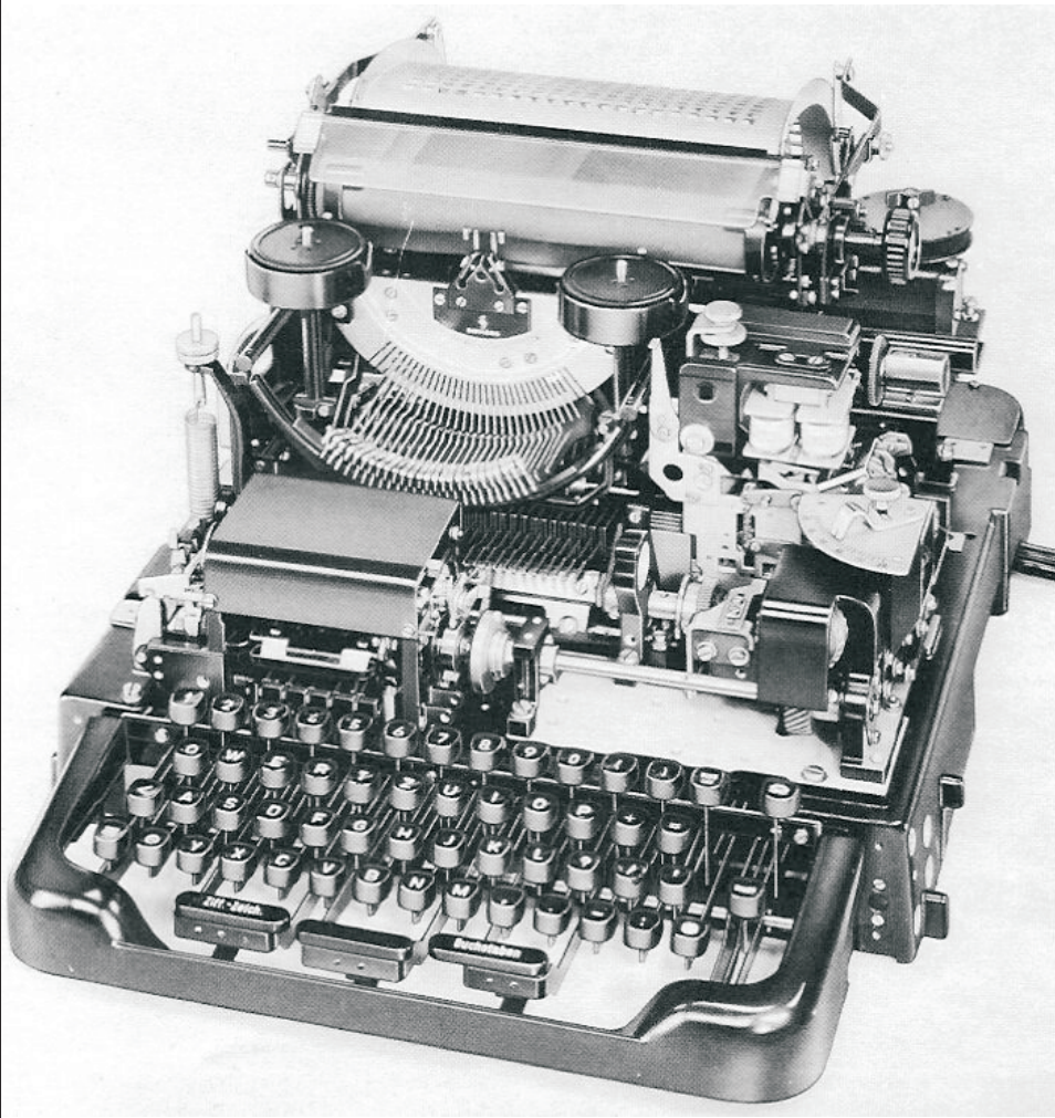
Im Springschreiber vereinigten sich Getriebetechnik, Werkstoffbehandlung und Herstellung zu einem feinmechanischen Kunstwerk. Das Bild zeigt eine offene Fernschreibmaschine Type Siemens 371
