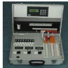
Ein ausgefeiltes **Starterkit** für die Simulation aller digitalen und analogen Werte ermöglicht das einfache Testen von selbst erstellten Programmen.
