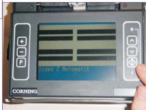
Beim Trennen von Fasern für den Spleißvorgang muss die Faserendfläche daher sauber, frei von Ausbrüchen, eben und rechtwinkelig zur Faserachse sein. Die Spleißgeräte erkennen Schmutzpartikel und mechanische Beschädigungen mit ihrer L-PAS-Videobildauswertung. Mit Hilfe eines Reinigungslichtbogens werden Verschmutzungen entfernt. Auf diese Weise ist gewährleistet, dass jederzeit eine möglichst optimale Spleißdämpfung erzielt wird und die Faservorbereitung
