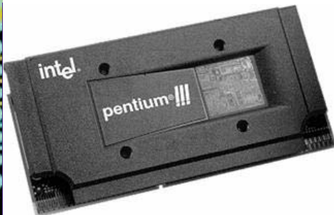
Intel Pentium III-Prozessor in der SEC-Kassette, dem neuen Gehäusetyp für Prozessoren (Foto:PCAustria).
