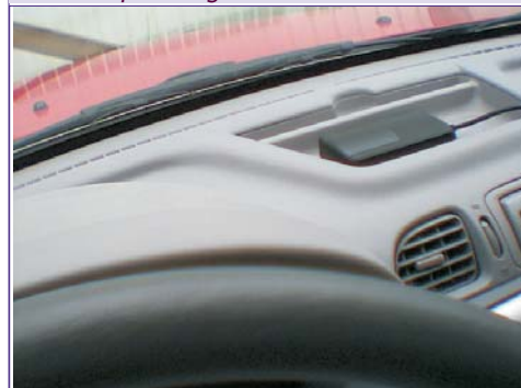
Die GPS-Antenne am Armaturenbrett
