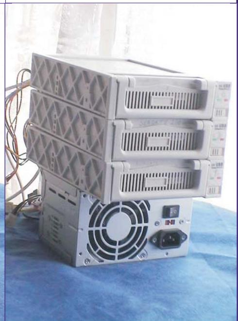
Das Gerät hat nach außen einen USB-Anschluss und benötigt die Stromversorgung an dem 4-poligen Stecker, der bei ATX-Netzteilen von Computern zum Anschluss von Platten und DVD-Laufwerken vorgesehen ist. Ein USB-Kabel liegt bei. Im Wechselrahmen befindet sich eine Kassette, wie ich sie bisher schon am Smart Shuttle verwendet habe. Die Kassette wird mit einem Schieber an der vorderen Stirnseite verriegelt, der auch die Stromversorgung der Platte einschaltet.
