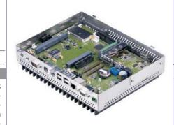
tät sind wichtige Leistungsmerkmale der UTX-Module. Die Prozessorleistung reicht von 133 MHz bis 1 GHz. Auf den Modulen ist die komplette Kernfunktionalität eines PCs integriert: CPU, Cache, RAM, Chipsatz, Grafik, Ethernet und Super I/O. Die UTX-Module sind untereinander Pin-kompatibel, so dass ein Wechsel beispielsweise zu einem leistungsstärkeren Prozessormodul problemlos möglich ist.
